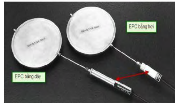
Hình 16: Thiết bị đo áp lực đất SPC
