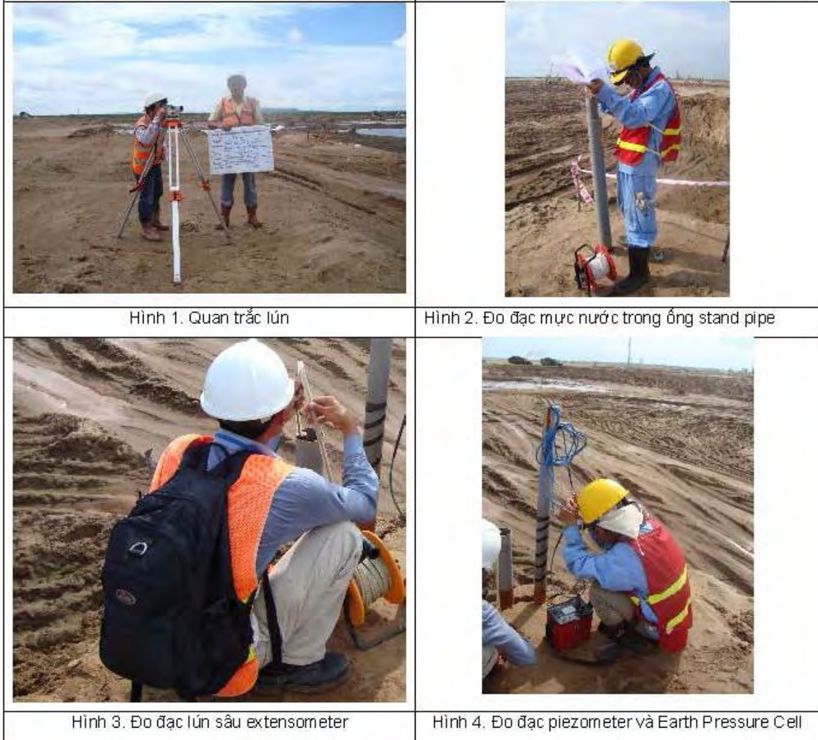
Hình 23: Một số hình ảnh đo đạc và quan trắc ở hiện trường xử lý đất yếu
